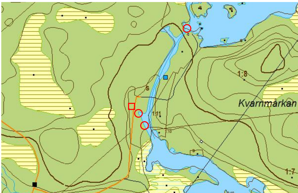
Figur 1. Karta över de utförda åtgärderna. Cirklar är anlagda lekbottenområden och fyrkanten är den åtgärdade vägtrumman. Två lekbottnar anlades per åtgärdat område.
